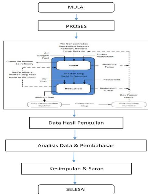
Gambar 3.1 Diagram Alir Percobaan
