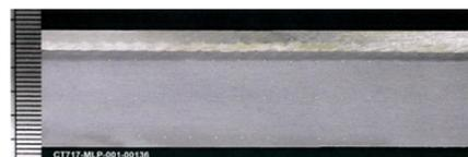
Gambar 4. 5 Foto makro 10x pembesaran – Weld overlay (Orientasi 0°)
