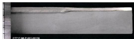
Gambar 4. 3 Foto makro 10x pembesaran – Transition Weld
