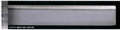
Gambar 4. 7 Foto makro 10x pembesaran – Weld overlay (Orientasi 240°)
