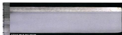
Gambar 4. 6 – Foto makro 10x pembesaran – Weld overlay (Orientasi 120°)
