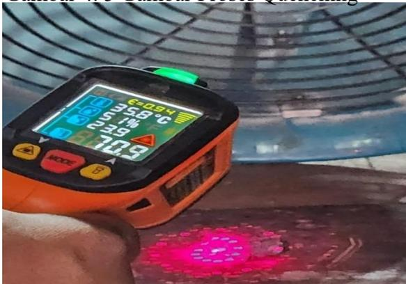
Gambar 4. 6 Proses pada saat after quenching di tahan sampai dengan 70-72°C
