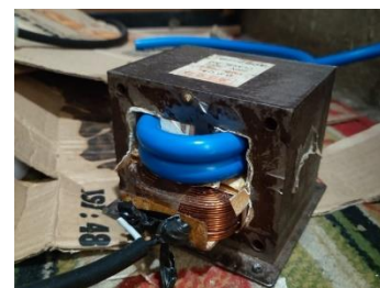
Modifikasi lilitan sekunder menggunakan kabel las 16 mm
