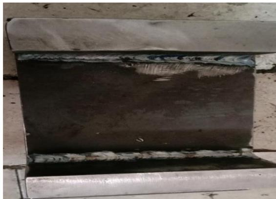
Gambar 4.13 Proses Mengelas bagian sisi ragum
