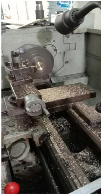
Gambar 4.3 proses pembubutan bushing
