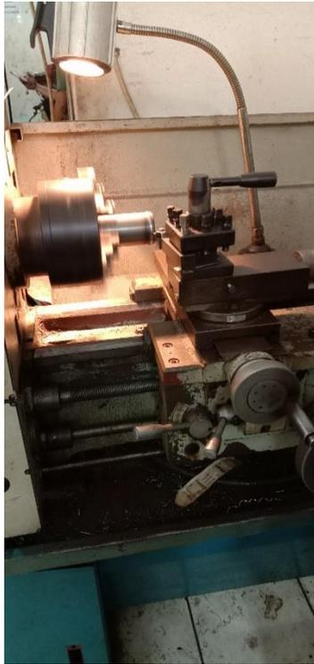
Gambar 4.1 Proses meratakan permukaan nozzle
