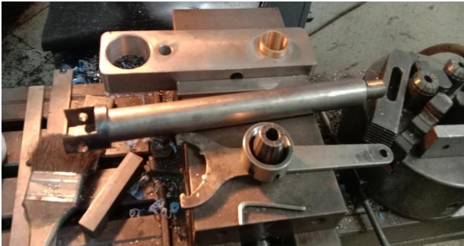
Gambar 4.6 Pemasangan Bushing pada penyangga 1
