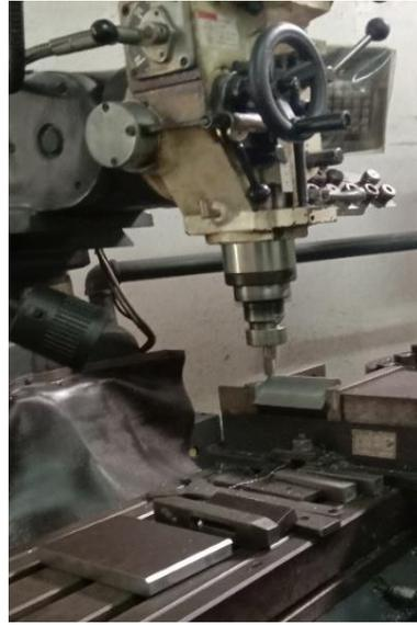
Gambar 4.12 Proses champer pemafrasan ujung material untuk bagian yang akan di las
