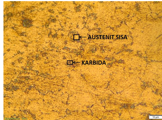
Gambar 3. 10 Struktur Mikro Baja JIS SUP 9 Perlakuan Panas Tempering Temperatur 380°C Dengan Media Pendingin Oli, Perbesaran 1000x.
