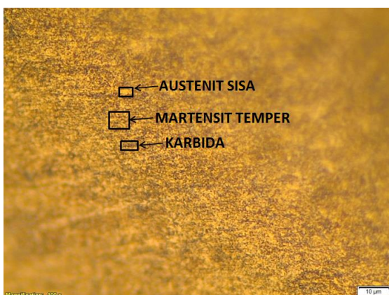
Gambar 3. 8 Struktur Mikro Baja JIS SUP 9 Perlakuan Panas Tempering Temperatur 420°C Dengan Media Pendingin Air, Perbesaran 1000x.
