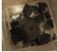
Gambar 3.2. Gambar terbentuknya \text{Na}_2\text{CO}_3 pada saat curing
