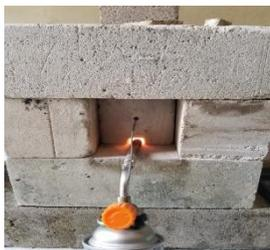
**Gambar 3.1** Tanur *furnace* buatan yang terbuat dari hebel yang di bentuk persegi dan membuat ruang pembakaran
