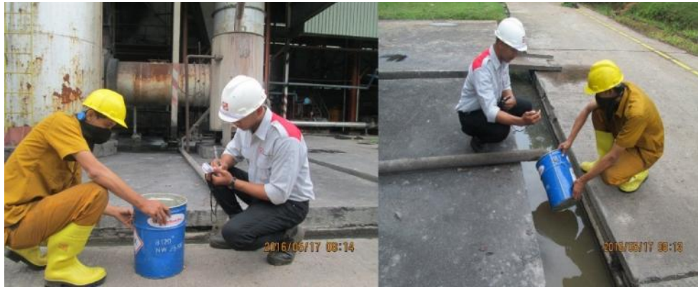
Gambar : 3.0 Pengukuran flowrate pada blowdown boiler
