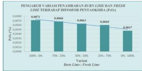
Gambar 3.3 Hasil Pengujian Difosfor Pentaoksida (P 2 O 5 )
