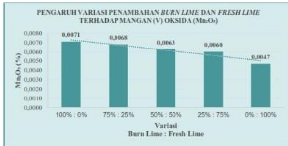
Gambar 3. 7 Hasil Pengujian Mangan (V) Oksida (Fe 2 O 3 )
