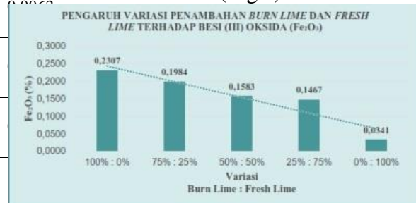
Gambar 3.6 Hasil Pengujian Besi (III) Oksida (Fe 2 O 3 )
