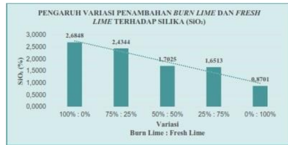
Gambar 3.4 Hasil Pengujian Silika (SiO 2 )
