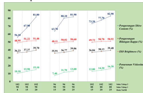
Gambar 6. Grafik Pengaruh Suhu dan Dosis NaOH terhadap Pengurangan Shive Content , Pengurangan Bilangan Kappa, Kenaikan Brightness , dan Penurunan Viskositas.
