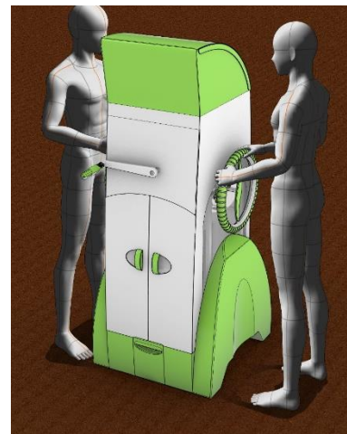
Gambar 4.7.14 Simulasi Dua Operator Sedang Memutar Setir Handle press (Sumber: Dokumentasi Pribadi, 2023)
