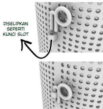
Gambar 4.5.11 Kunci Slot Wadah Press (Sumber: Dokumentasi Pribadi, 2023)
