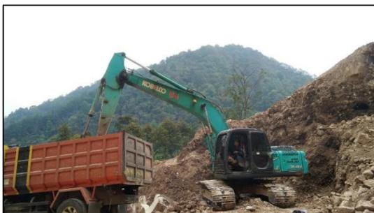
**Gambar 9.** Pola Pemuatan *Bottom Loading*
