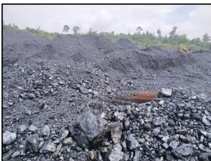
Gambar 9. Keadaan ROM yang Basah dan Ukuran Partikel Tidak Seragam
