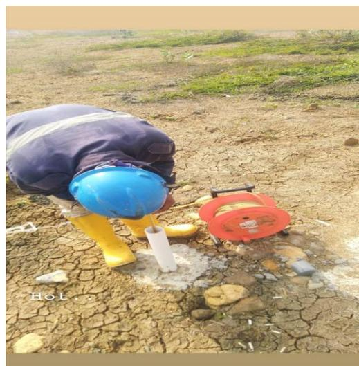
Gambar 8. Pengukuran Kontur Muka Air Tanah Menggunakan Water Leveling.
