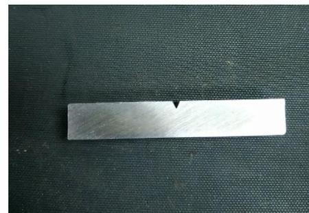
Gambar 9: Spesimen CVN Tests
