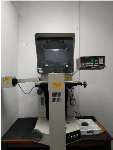
Gambar 11: Mesin Proyektor *V-Notch*
