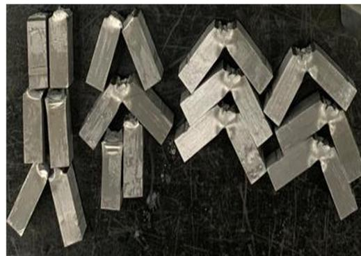
tinggi yang menentukan jumlah energi yang diserap oleh bahan selama terjadi patahan. Energi yang diserap adalah ukuran ketangguhan bahan tertentu dan bertindak sebagai alat untuk belajar bergantung pada suhu transisi ulet getas. Pengujian di lakukan mengacu pada test methode ASTM E23-
