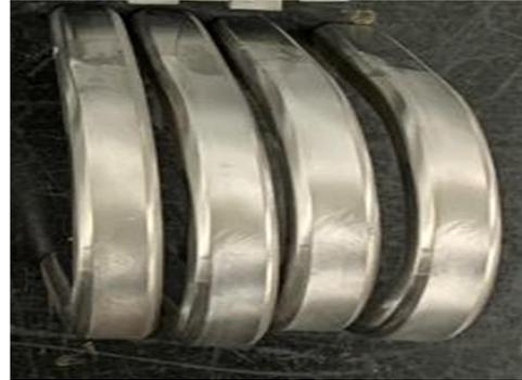
Gambar 10 Hasil pengujian bend test
