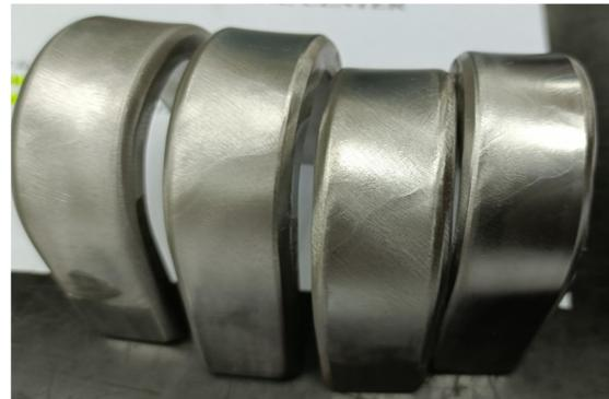
Gambar 15 Hasil pengujian bend test
