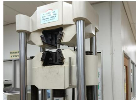
Gambar 4 Mesin Tensile test
