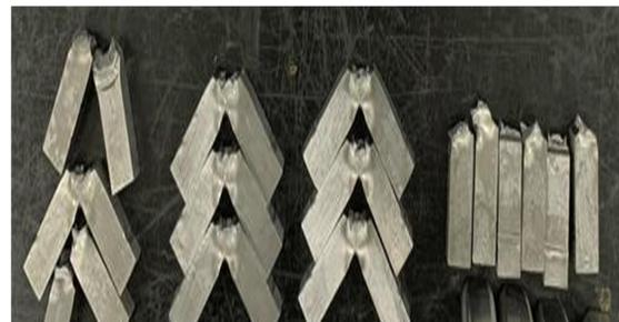
Gambar 16 Hasil pengujian charpy
