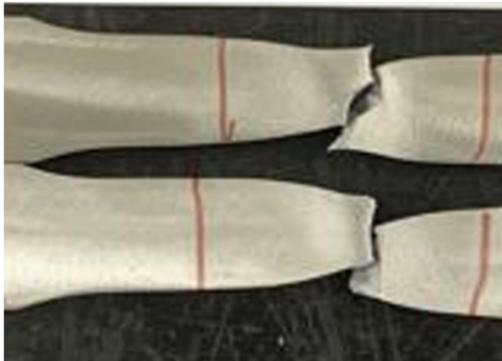
Gambar 14 Hasil pengujian tensile test
