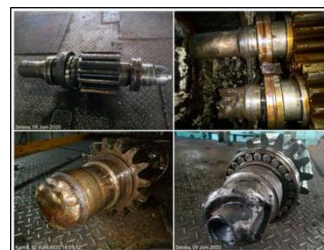
Gambar 8. Kegagalan komponen main shaft
