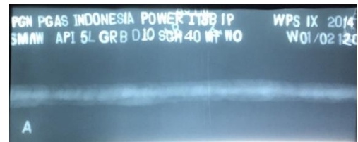
Gambar 3.1 Film radiografi hasil lasan pada weld original (tanpa repair)
