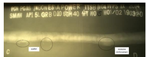
Gambar 3.3 Film radiografi hasil lasan pada repair welding 5x
