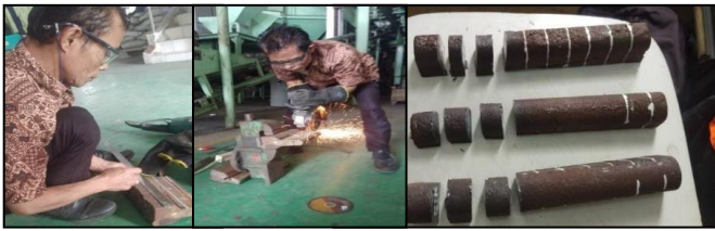
Gambar 3. 10 Proses Pemotongan Sampel Y-Block
