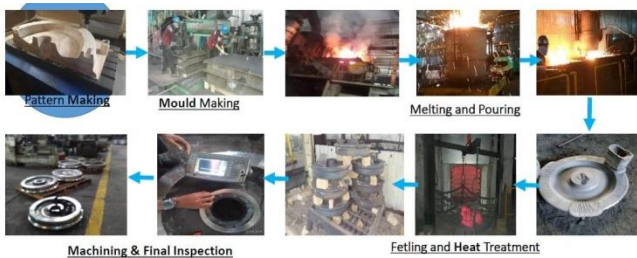
Gambar 4. 1 Proses Pengecoran Roda Kereta Api (Sumber: Litbang pembuatan roda kereta api untuk substitusi impor)
