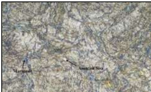
Gambar 7. Struktur Mikro Pada Media Oli Di Temperatur 775
