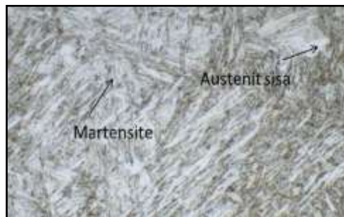
Gambar 2. Struktur Mikro Pada Media Air Di Temperatur 735
