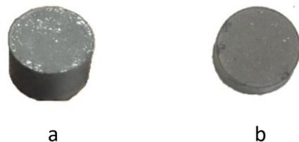
**Gambar 3** (a) sampel hasil kompaksi sebelum pemanasan, (b) sampel hasil kompaksi yang telah pemanasan.
