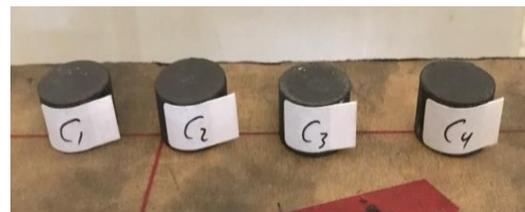
**Gambar 1** serbuk *calcined petroleum coke* setelah melalui proses kompaksi
