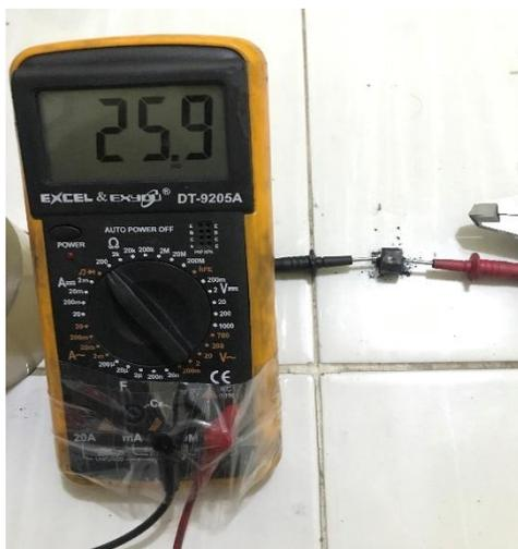
**Gambar 2** rangkaian pengujian resistivitas
