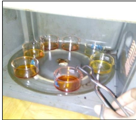
Gambar 3.5 Proses Pemanasan Sampel Pada Microwave Oven
