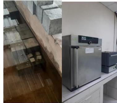
**Gambar 1 Alat Pengujian Porositas dan Daya Serap Air**
