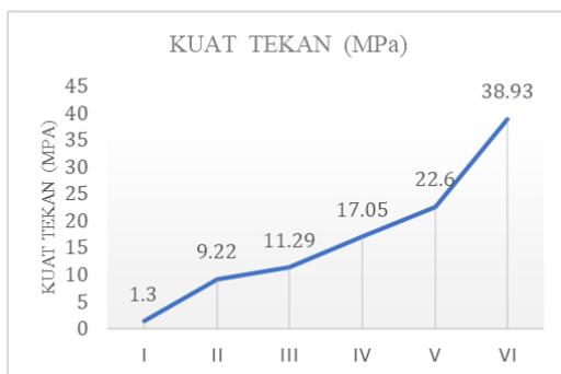
Gambar 6 Hasil Uji Kuat Tekan *Paving Block*
