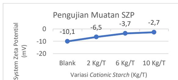
**Gambar 2** Grafik Pengujian SZP Setelah Treatment *Anionic Trash*
