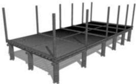
Gambar 4 struktur panggung Sumber: Kajian Arsitektur Vernakular
