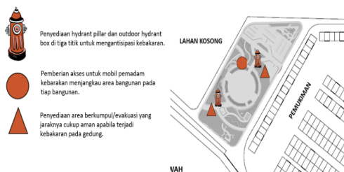
Gambar 18 Sistem Proteksi Kebakaran
