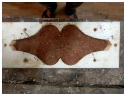
**Gambar III.3.4.** proses cetak.
