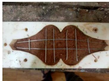
**Gambar III.3.5.** Pemasangan kerangka.
