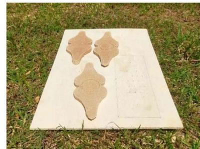
**Gambar III.3.6.** proses pengeringan modul.
